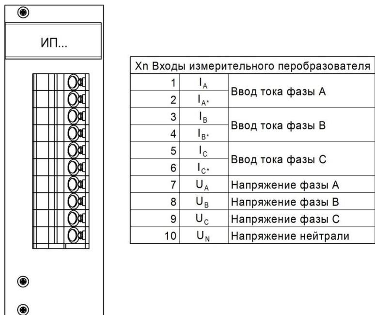
Рисунок 9 - Плата измерительного преобразователя
